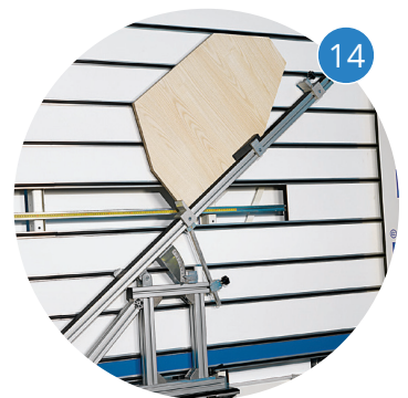
Dispositivo taglio inclinato Dispositif pour coupe d'angle
