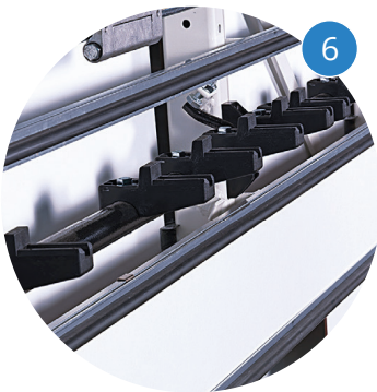
Dispositivo pezzi corti lato destro Rail rabattable pour couper petits panneaux sur le côté droit
